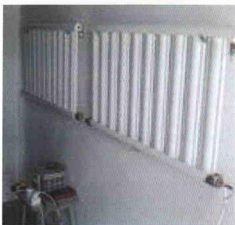
**Рис. 2.** Экспериментальная установка для исследований энергоэффективности радиатора «Absorb» (слева) и классического (справа), электрический метод
