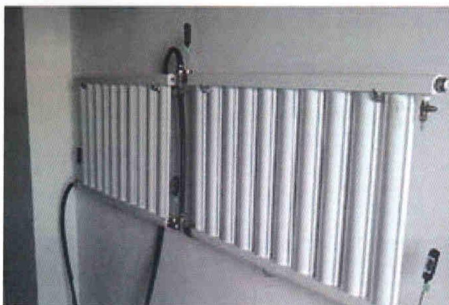
Рис. 1. Экспериментальная установка для исследований энергоэффективности радиатора «Absorb» (слева) и классического (справа), водяной метод
